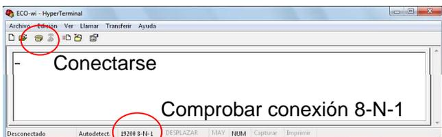
Se aceptan todas las configuraciones y se coloca el switch del ECO-RS-USB-wi en la opción 19200 bit/s, y se conecta al PC.
