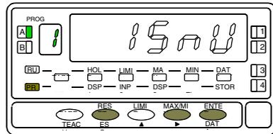
Se visualiza en display el rango de entrada programado previamente. Si el rango ya es el requerido, pulsar **ESC** para volver al modo de trabajo. Si se desea modificar este parámetro, pulsar sucesivamente la tecla **▶** hasta que aparezca en display la selección deseada ["15mV", "30mV", "60mV" ó "300mV"].
