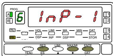
La figura 32.1 muestra la indicación (InP-1) correspondiente al menú de configuración de la función del PIN 1. Pulsar la tecla **ENTER** para acceder a este menú.
