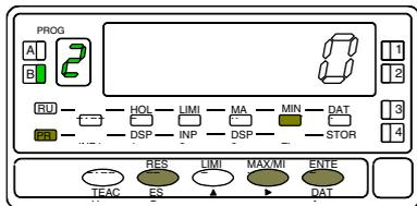
Programación del valor del filtro de estabilización, led FLT encendido. Introducir el nivel de filtro deseado, un valor de 0 a 9, mediante la tecla **▶** para modificar el valor.
