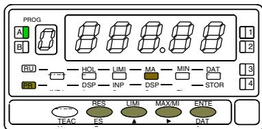
Programación del valor del display en el punto 4, led DSP2 encendido. Introducir el valor dígito a dígito y de izquierda a derecha. Presionar sucesivamente la tecla para modificar el dígito en intermitencia y la tecla para desplazarse al dígito de la derecha hasta completar el valor y el signo deseado. El valor máximo es +32000 puntos y el valor mínimo -32000 puntos. Un valor superior o inferior dará error, dejando 32000 con el signo correspondiente. Introducido el valor deseado:
