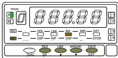
Programación del valor del display en el punto 2, led DSP2 encendido. Introducir el valor dígito a dígito y de izquierda a derecha. Presionar sucesivamente la tecla para modificar el dígito en intermitencia y la tecla para desplazarse al dígito de la derecha hasta completar el valor y el signo deseado. El valor máximo es +32000 puntos y el valor mínimo -32000 puntos. Un valor superior o inferior dará error, dejando 32000 con el signo correspondiente. Introducido el valor deseado:
