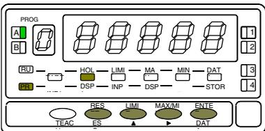
Programación del valor del display en el punto 1, led DSP1 encendido. Introducir el valor dígito a dígito y de izquierda a derecha. Presionar sucesivamente la tecla **▲** para modificar el dígito en intermitencia y la tecla **▶** para desplazarse al dígito de la derecha hasta completar el valor y el signo deseado. El valor máximo es +32000 puntos y el valor mínimo -32000 puntos. Un valor superior o inferior dará error, dejando 32000 con el signo correspondiente.
