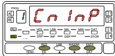
Partiendo del modo de trabajo, pulsar la tecla **ENTER** para entrar en el modo de programación (se visualiza la indicación -Pro-). Pulsar entonces la tecla **▶** y el display mostrará la indicación de la figura 14.1. Correspondiente al nivel de acceso al módulo de programación de la entrada.
