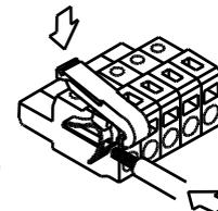
Proceder de la misma forma con todos los terminales y volver a enchufar la regleta en el conector.
