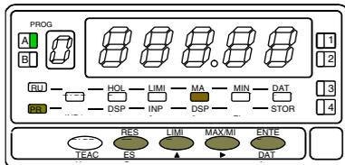
Programación del valor del display en el punto 30, led DSP2 encendido. Introducir el valor dígito a dígito y de izquierda a derecha. Presionar sucesivamente la tecla para modificar el dígito en intermitencia y la tecla para desplazarse al dígito de la derecha hasta completar el valor y el signo deseado. El valor máximo es +32000 puntos y el valor mínimo -32000 puntos. Un valor superior o inferior dará error, dejando 32000 con el signo correspondiente.
