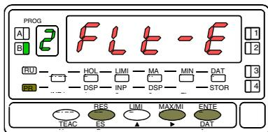
La figura 23.1 muestra la indicación (**FLt-E**) correspondiente al menú de filtro de estabilización. Pulsar la tecla **ENTER** para acceder a este menú.
