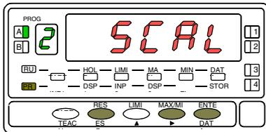
La figura 17.1 muestra la indicación (**SCAL**) correspondiente a la entrada en el menú de configuración de la escala. Pulsar la tecla **ENTER** para acceder a este menú.
