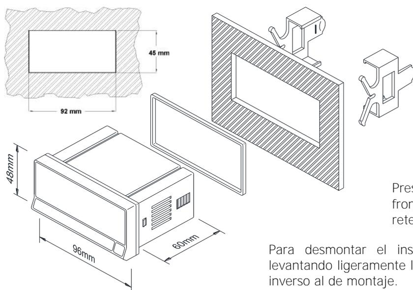
Para montar el instrumento en panel, abrir un orificio de dimensiones 92x45mm e introducir el instrumento en el mismo por la parte delantera, colocando la junta de estanqueidad entre éste y el panel.
