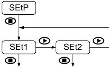
El tercer menú aparece únicamente cuando la opción de salida de dos relés está instalada. Para más detalles sobre los modos de funcionamiento consultar más adelante en este manual el apartado correspondiente a la opción de salida.
