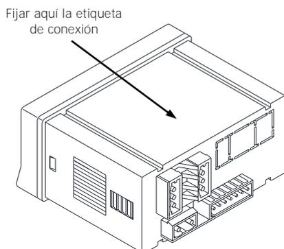
Una vez montada, y encajado de nuevo el aparato, los conectores deberán salir por el orificio obtenido.
