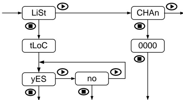
Al escoger "LiSt" aparece por unos instantes la indicación "tLoC". Al escoger "yES" se activa el **bloqueo total** y se salta directamente a la configuración de bloqueo de la función TARA y tecla MAX/MIN, para luego volver al modo **RUN**. Estando el aparato totalmente bloqueado se podrá acceder a toda la configuración, si bien **no será posible introducir y/o modificar datos**. Al entrar en el menú principal aparecerá "dAtA" en lugar de "Pro".
