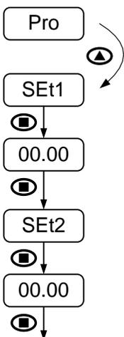
Si el equipo lleva instalada una opción de salida de relés, es posible acceder de forma directa a configurar los valores de setpoint sin tener que pasar por el menú de configuración principal.
