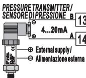
Para señales lineales 0 / 4..20 mA con alimentación externa del sensor.
