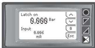
Para usar la función LATCH ON: introduzca la configuración, seleccione Configuración en el parámetro 8, Latch on y presione "Sel" (muestra la página en la imagen).
