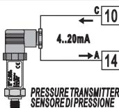
Para señales lineales 0 / 4..20 mA con sensor de dos hilos.
