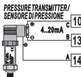
Para señales lineales 0 / 4..20 mA con sensor de tres hilos.
