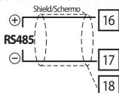
Comunicación RS485 Modbus RTU
