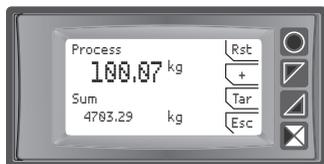
Presione "Sum Function" para acceder a la página de funciones. Al presionar "+", el valor del Proceso se agrega al contador. Es posible restablecer el valor total manteniendo presionado "Rst" y fijar "tara cero" del proceso presionando "Tar".
