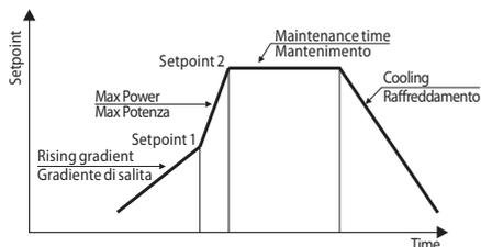
El ciclo comienza en cada activación del controlador, o mediante la entrada digital si está habilitado para este tipo de funcionamiento (parámetros 231, 239, configurados como  $St.i.5t.$  or  $RuM$ ).
